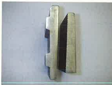
② 内リング及び外リングの切断面状況
