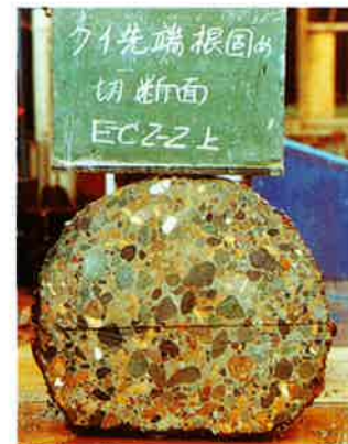
● 拡大球根の断面 拡大球根の断面は、支持層の砂礫と根固め材とが十分混合して均一なコンクリート形成しております。
