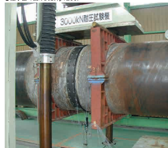
●継手部の曲げ試験(φ1200)
