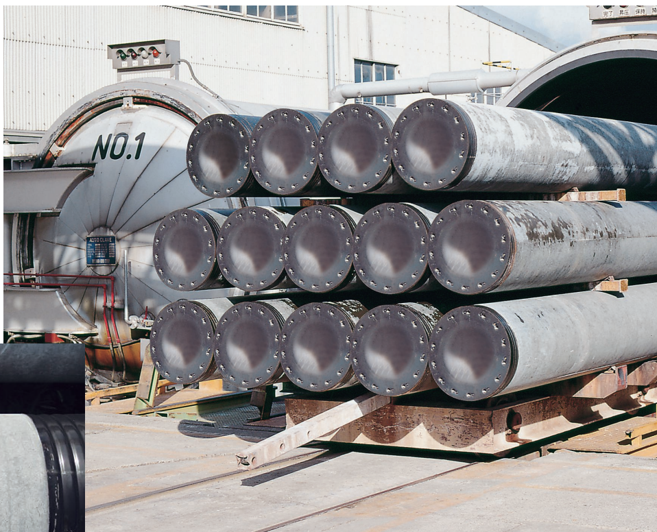
高温・高圧養生されるPHCパイル
