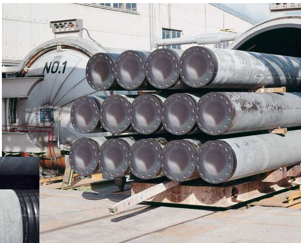
高温・高圧養生されるPHCパイル
