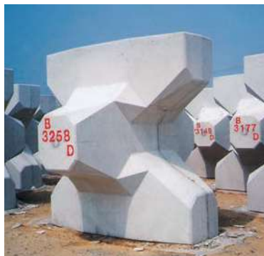
消波ブロック「アクロポッド®」 独特な形状により一層積みでも確実な被覆ができる経済的な消波ブロック
