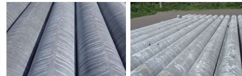
横置き保管中のポールにエフロレッセンスが発生すると左写真のようなゼブラ模様になります。
